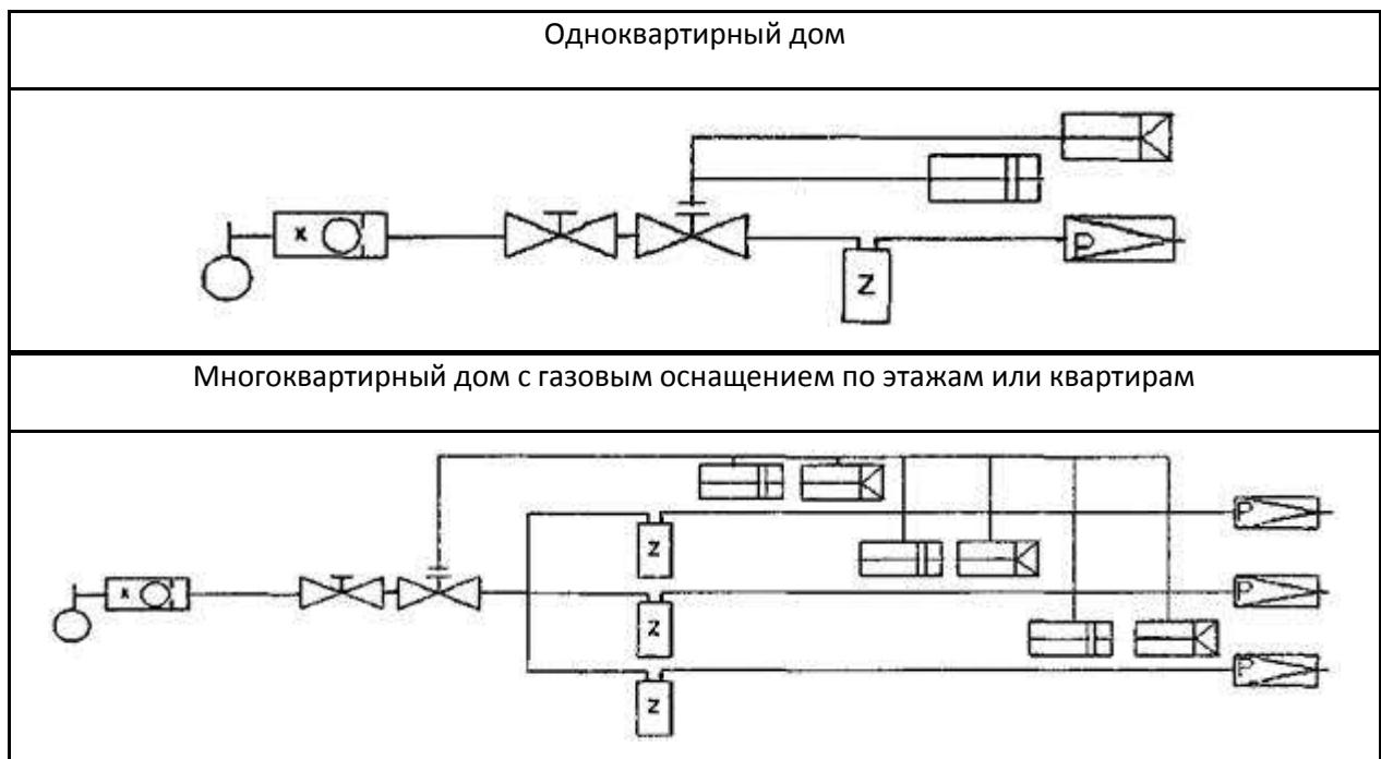
**Рисунок Д.1 - Активные меры безопасности при давлении в наружном газопроводе
