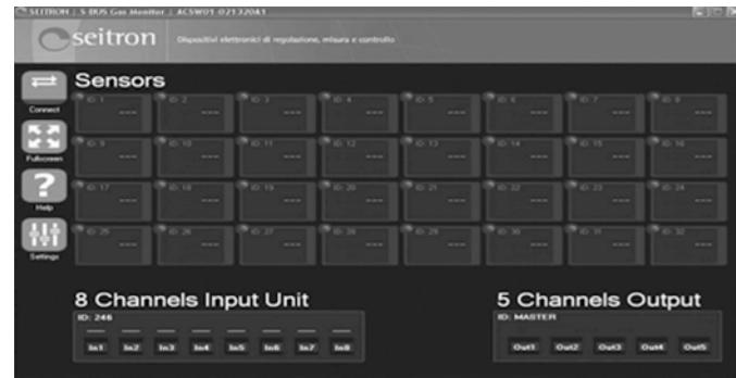
ПК, на котором установлено ПО **Gas Monitor**, должен получать данные от системы контроля загазованности по протоколу **RS485-USB** серийный адаптер, подключенный к свободному слоту USB.
