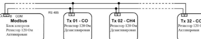
Рис. 3. Пример активирования резистора: Блок контроля - сенсор
